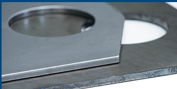
Laserem řezané díly před a po zpracování s EdgeBreaker® 2000.
